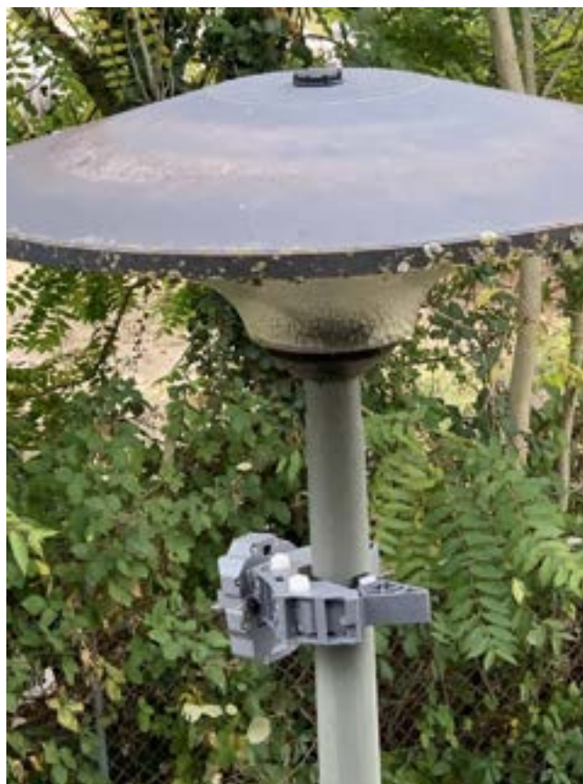
Figuur 1: Een sensor van NSM (genaamd 'bat puck' aan een lichtmast in Limburg. Bron foto: Peter Twisk
